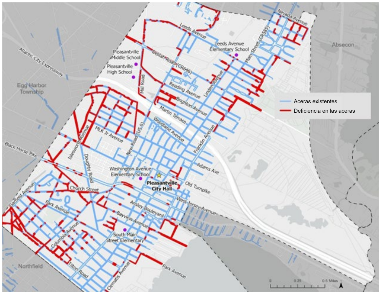
Imagen 3.7: Evaluación de deficiencias en la acera
